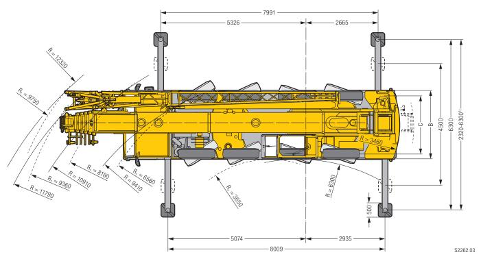
R<sub>1</sub> = Allradlenkung · All-wheel steering · Direction toutes roues · Tutti gli assi sterzanti · Dirección en todos los ejes · Поворот всеми колесами 1) **nur mit VarioBase®** · only with VarioBase® · seulement avec VarioBase® · solo con VarioBase® · sólo con VarioBase® · только с VarioBase®
